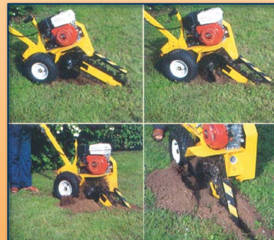
Catenaria per piccoli scavi profondità scavo 30cm. larghezza 8cm
